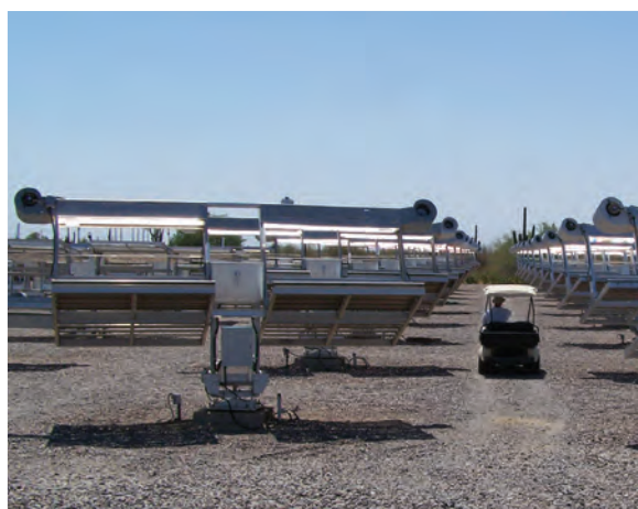
相关性研究显示，Q-TRAC 对于测试卷材涂料、粉末涂料、建筑涂料和某些塑料特别有用。
