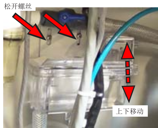
10. 松开供水组件背板上的螺丝，上下移动去调节湿球供水管里的水位。
