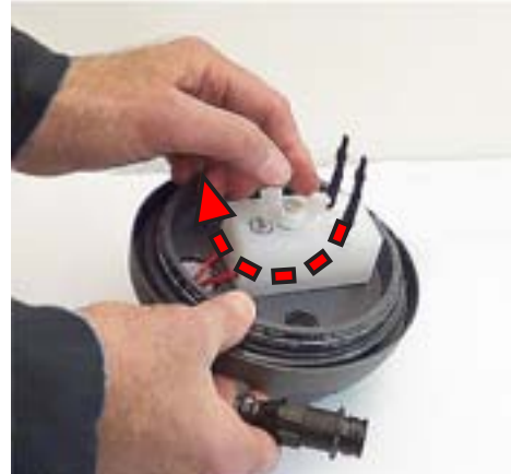
16. 如图位置对准好传感器。重新安装螺母，拧紧。
