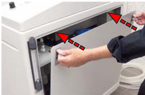
18. 重新安装Q-FOG 侧板。
