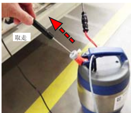
53. 取走保温校准桶里的温度计。
