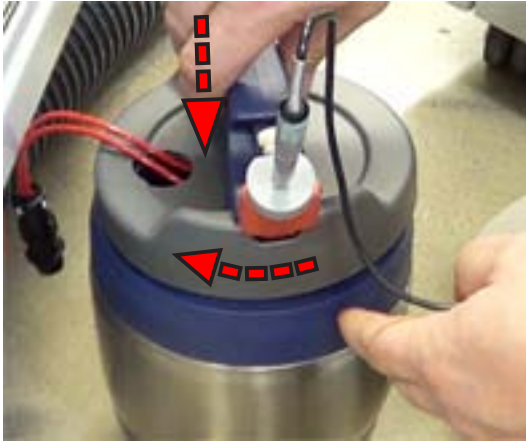
23. 合上保温校准桶的盖子。拧紧盖子。
