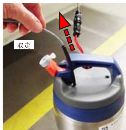
54. 取走保温校准桶里的箱体温度传感器。
