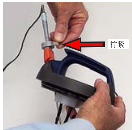
22. 拧紧温度计安置口的螺丝让它固定温度计在正确的位置。
