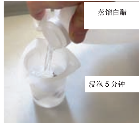
8. 放入旧喷嘴的烧杯内加一半 (50 ml) 的蒸馏白醋。浸泡 5 分钟。
