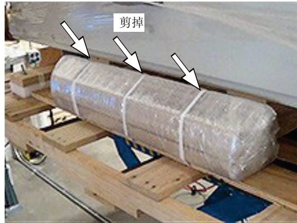
11. 用刀割开托盘上固定样品架包装的束缚带, 取出样品架
