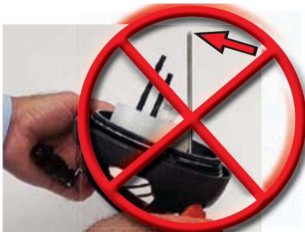
21. 确保温度计传感器 没有伸出干湿球的位置。
