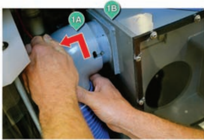
从鼓风机模块(1B)这边断开空调气管 (1A)。
