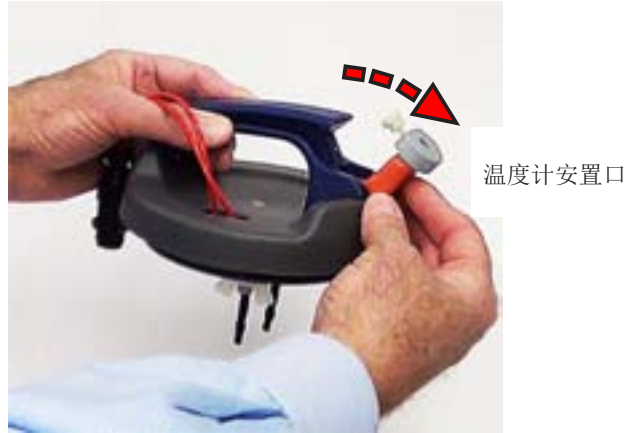
18. 旋转校准桶盖子上的温度计安置口后取走。
