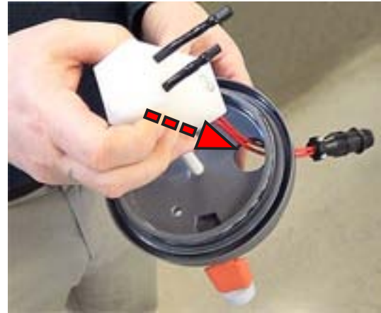
14. 从盖子的内部，把干湿球连线通过盖子上的大孔穿过。
