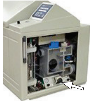
电磁阀在模块搁板的下
