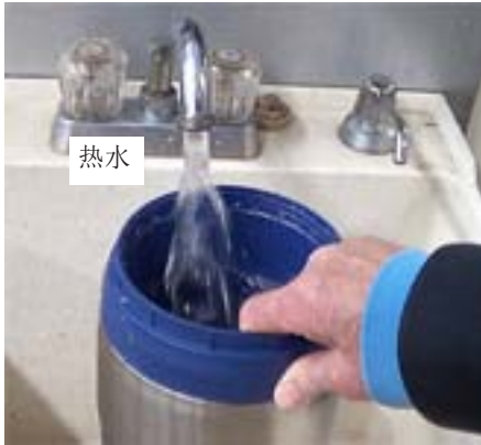
17. 在保温校准桶里加满热水。热水的温度应该和测试标准里设备的最高温度相接近。
