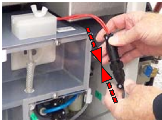
17. 重新连接干湿球的连接线。
