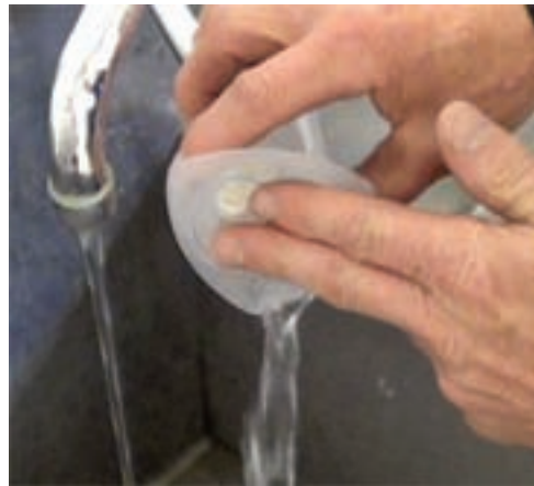
12. 用净水倒掉灌满来回 4 次去冲洗喷嘴。
