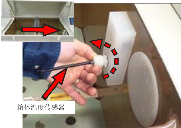
25. 在Q-FOG测试箱右侧，松开固定箱体温度传感器的螺母。
