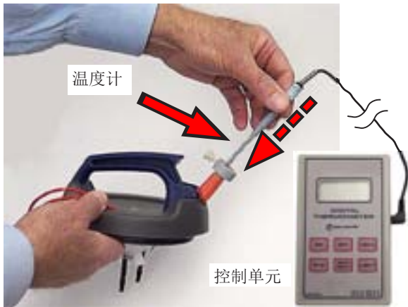
19. 将相关温度计从盖子上的温度计安置口内插入。
