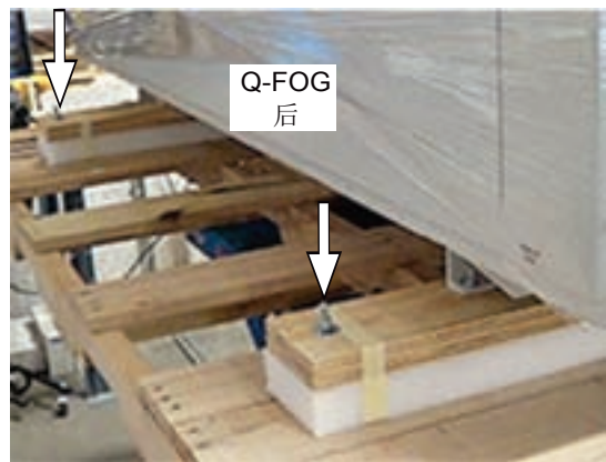
11. 用刀割开托盘上固定样品架包装的束缚带, 取出样品架
