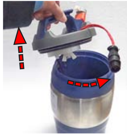
58. 打开保温校准桶的盖子。
