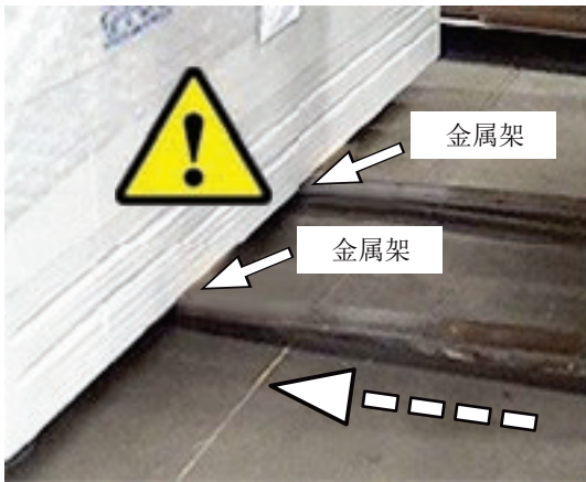
15. 确保叉车叉在盐雾箱的垫仓板。查看Q-FOG前面提示叉车正确位置的标签。
