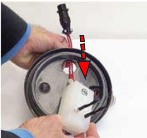
61. 从盖子的洞里取出干湿球的连线。
