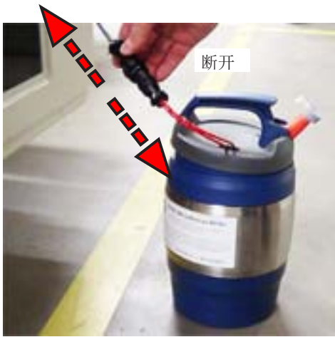
57. 断开干湿球连接线。
