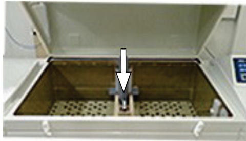
加湿器在均化板下面
