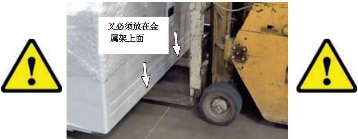
15. 确保叉车叉在盐雾箱的垫仓板。查看Q-FOG前面提示叉车正确位置的标签。
