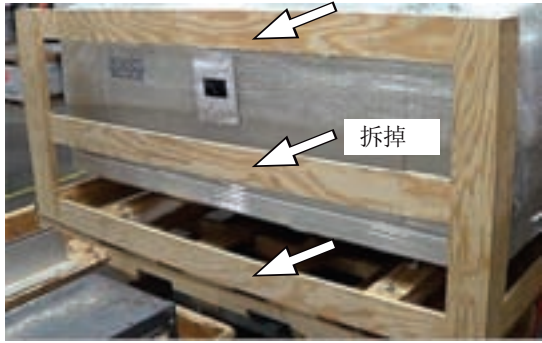
9. 拆下两侧的水平支撑板
