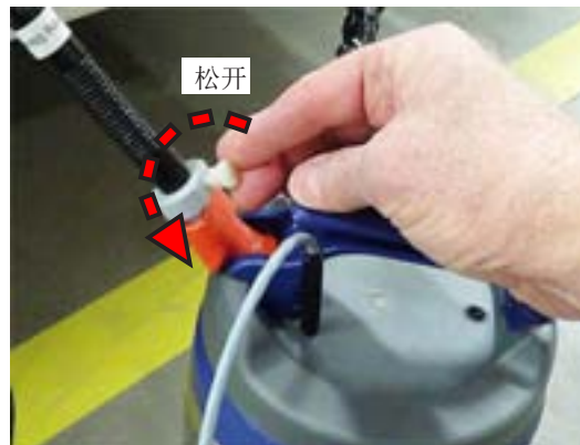
52. 松开保温校准桶盖子上温度计安置口的螺丝。
