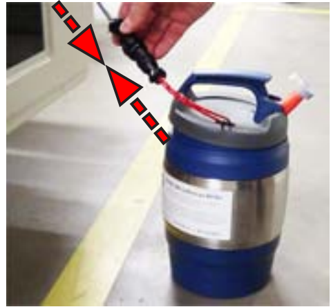
24. 重新连接干湿球连接线。
