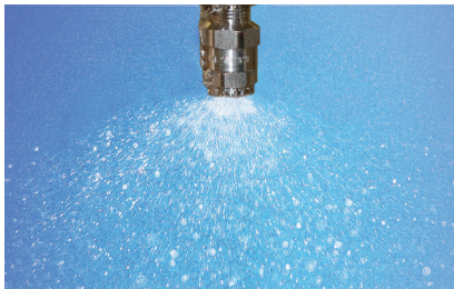
通过纯水喷淋到样品表面来模拟户外湿气的 影响。
