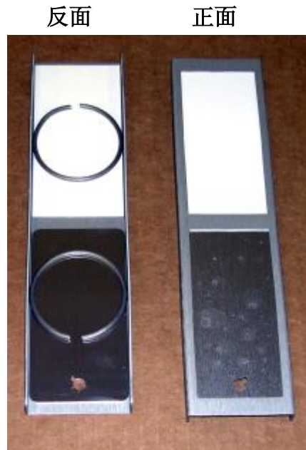
图 28e: 2x4 英寸面板固定器固定 3mm 厚的塑料样品
