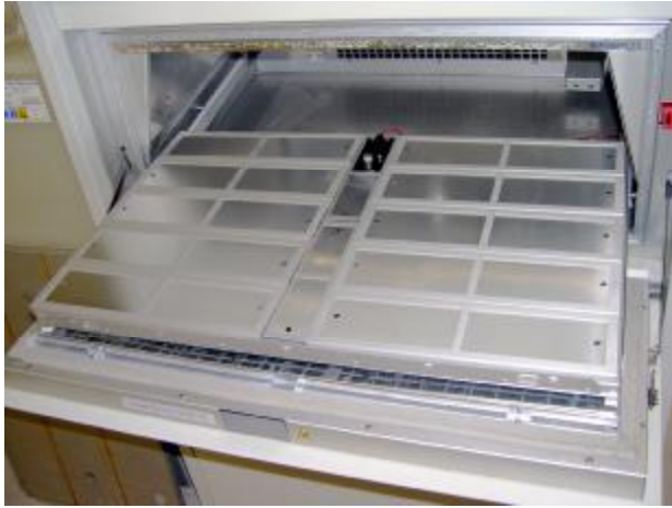
图 28h: Xe-3 机型样品盘上(10) 3x6 英寸面板固定器
