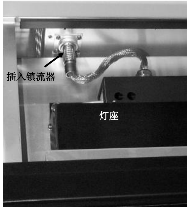
图76b: Q-Sun Xe-1 连接灯座和镇流器的电线和插头
