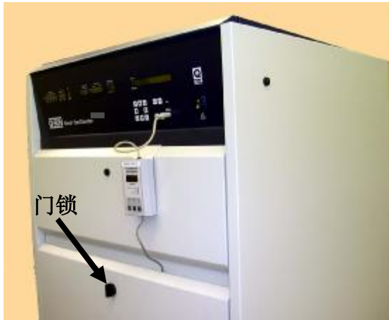
图41a: CR20的电源线从箱门上引出(远离门锁) 图41b: CR20的电源线从箱门上引出 (远离门锁)
