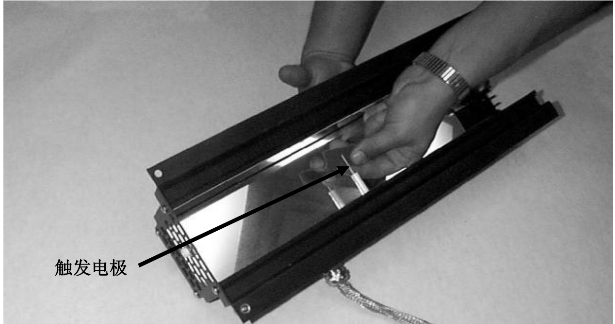
图80：清洁灯座和触发电极
