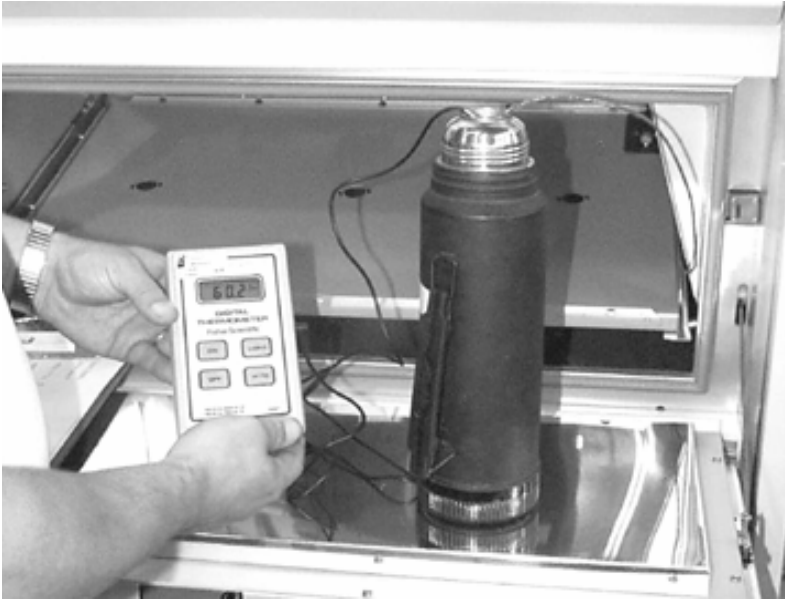
图46：传感器放入绝热杯里
