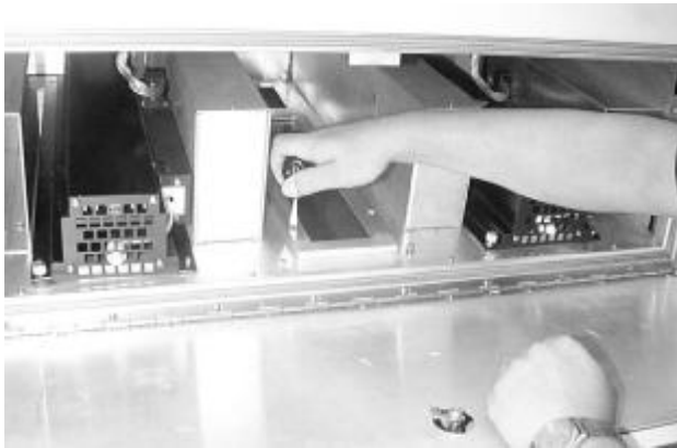
图27a: 松开螺丝，取出固定架
