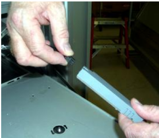
图46c：在管中取出相对湿度/箱体空气温度传感器
