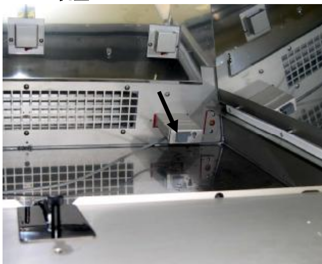
图22a: 箱体温度传感器及湿度传感器
