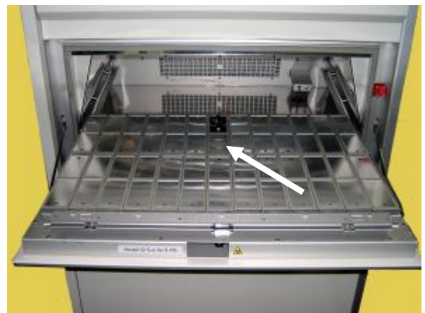
图 28r: Xe-3 机型样品盘上参考材料的位置(利用了面板固定器)
