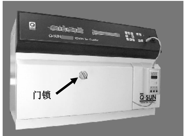
图41a: CR20的电源线从箱门上引出(远离门锁) 图41b: CR20的电源线从箱门上引出 (远离门锁)
