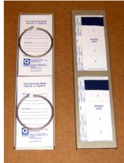
图 28p: 纺织品遮盖板安装在固定器上
