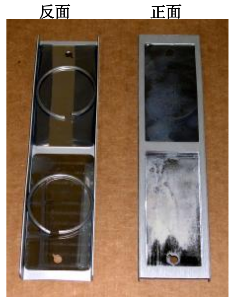
图 28l: 薄膜安装在面板固定器上
