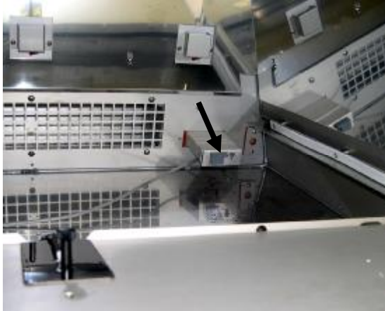
图46a：相对湿度/箱体空气温度传感器
