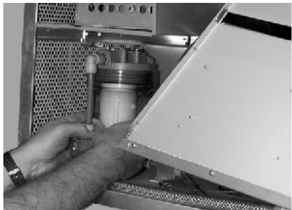
图87d: Q-Sun Xe-1 取出水过滤器
