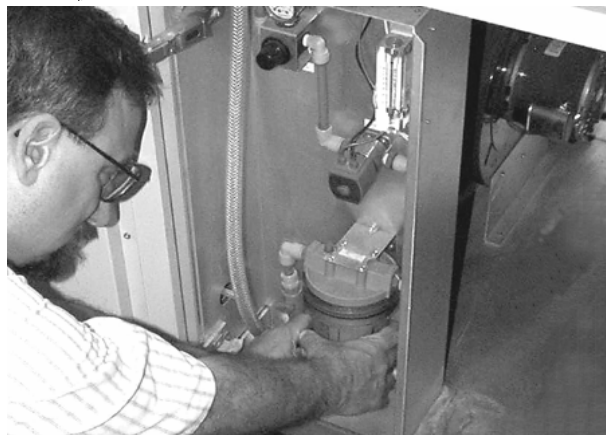
图87c: Q-Sun Xe-3 取出水过滤器
