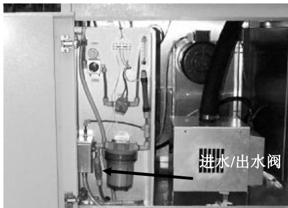
图87a: Q-Sun Xe-3水开/关阀门
