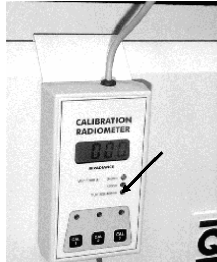
图37：LED指示测量的波长
