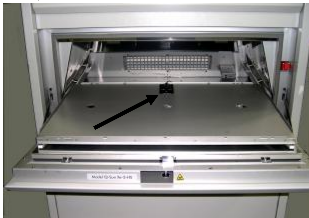
图21a: 温度传感器的安装位置
