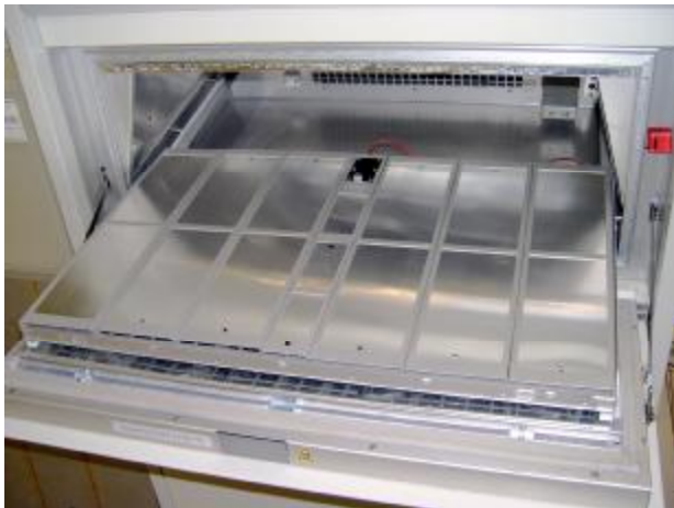
图 28j: Xe-3 机型样品盘上(6) 4x8 英寸面板固定器
