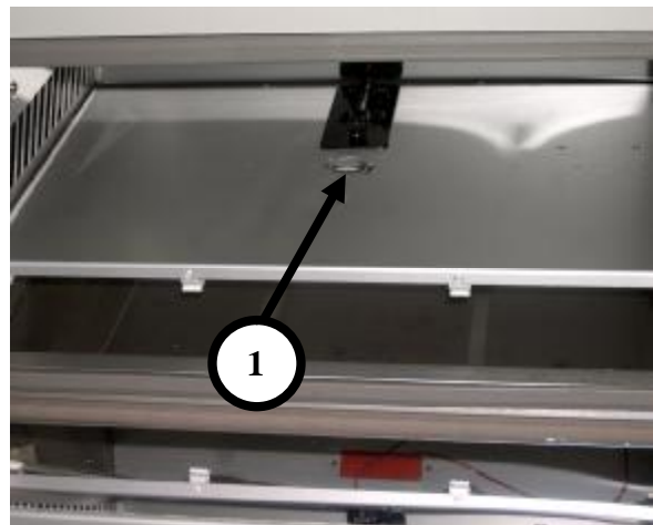
图38b：样品托盘上的1校准点
