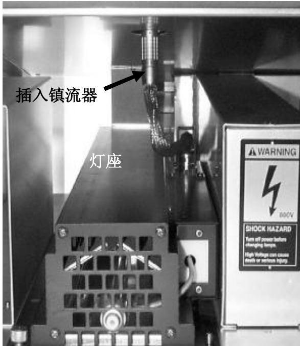
图76a: Q-Sun Xe-3 连接灯座和镇流器的电线和插头
