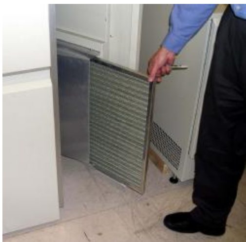
图86a：Q-Sun Xe-3 取出空气过滤网
