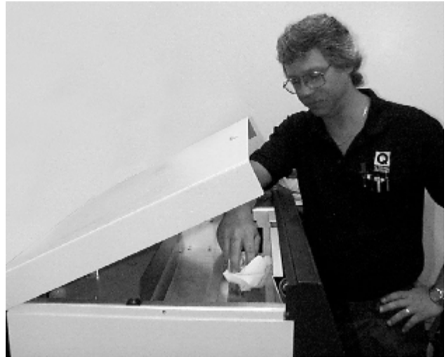
图83b: Q-Sun Xe-1 用软布和酒精清洁过滤片
