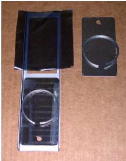
图 28k: 薄膜放置在面板固定器上
