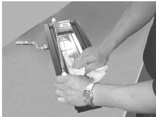
图82b: Q-Sun Xe-1 清洁UV反射镜
