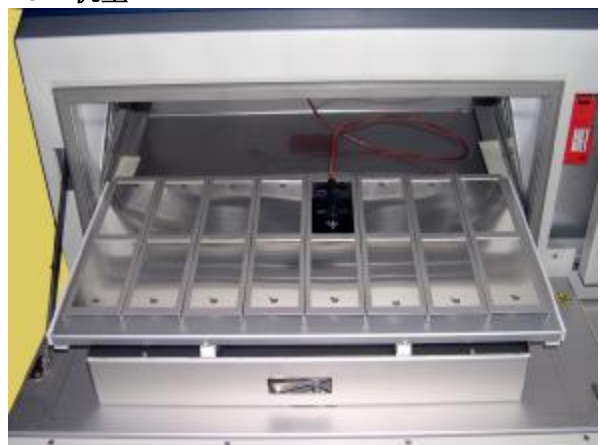
图 28g: Xe-1 机型样品盘上(8) 2x4 英寸面板固定器
