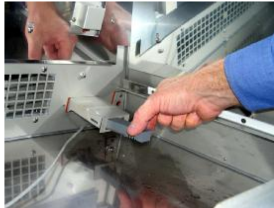
图46b：取出相对湿度/箱体空气温度传感器
