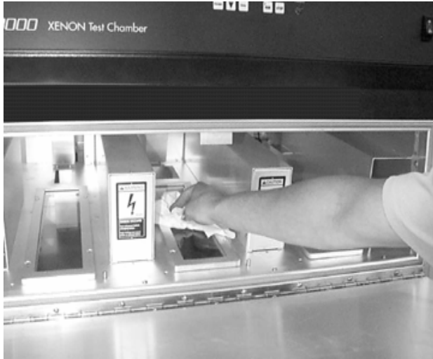
图83a: Q-Sun Xe-3 用软布和酒精清洁过滤片
