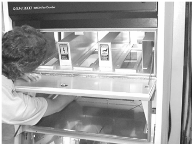
图84a: Q-Sun Xe-3 清洁过滤片的底部
