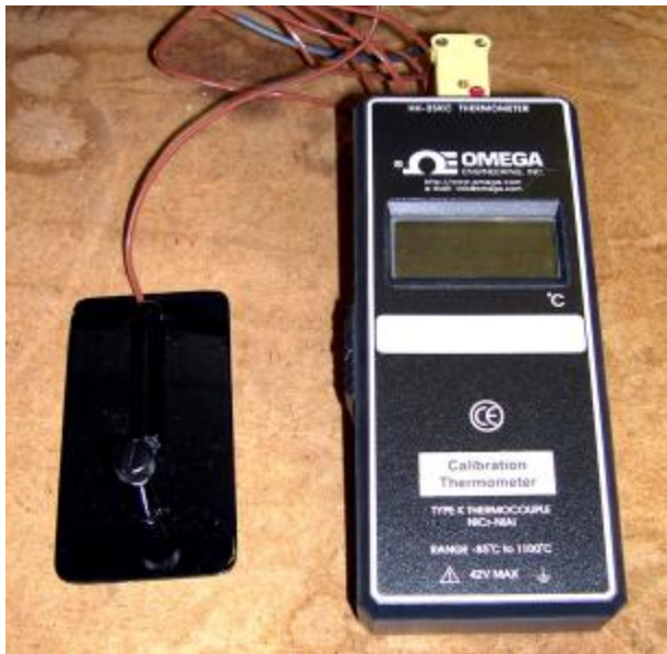
图47：CT202黑板温度传感器校准仪
