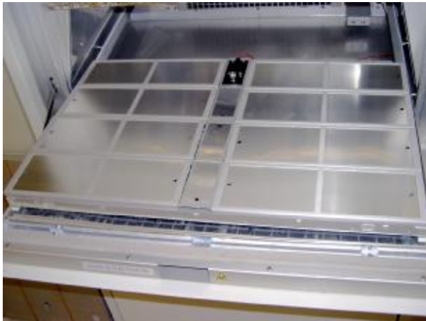
图 28i: Xe-3 机型样品盘上(8) 4x6 英寸面板固定器
