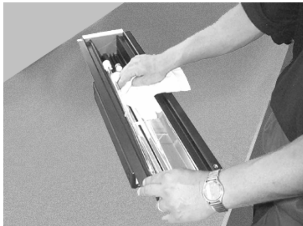
图82a: Q-Sun Xe-3 清洁UV反射镜
