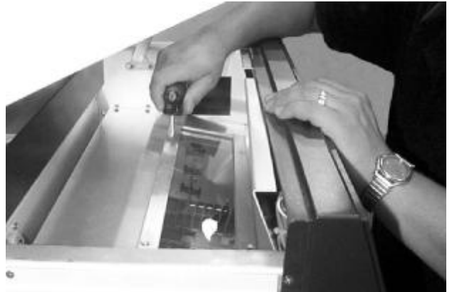
图27b: 松开螺丝，取出固定架
