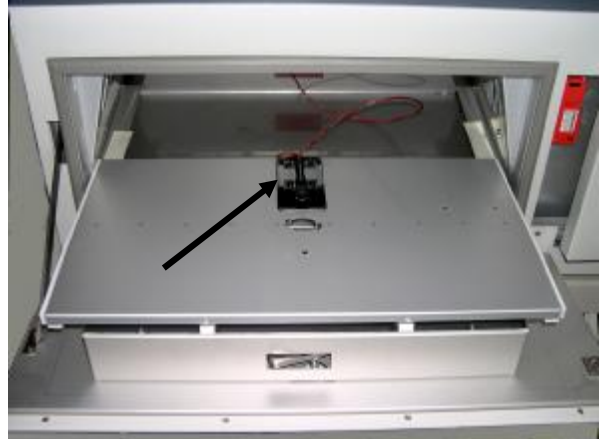
图49b: 黑板温度传感器的位置
