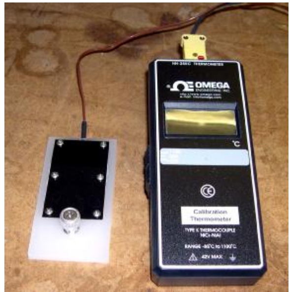
图48：CT202绝热黑板温度传感器校准仪
