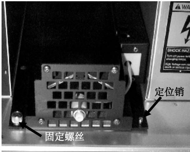
图77a: Q-Sun Xe-3 定位销和灯座上的螺丝
