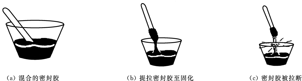
图 D.4 拉断时间试验
