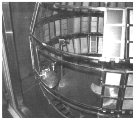
图2 在转鼓式装置里，收集在加速老化测试时从标准油漆试板上流下的水量
