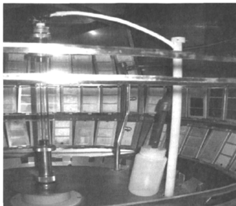
图1 在转鼓式加速老化设备的测试过程中，从喷嘴收集水的试验装置
