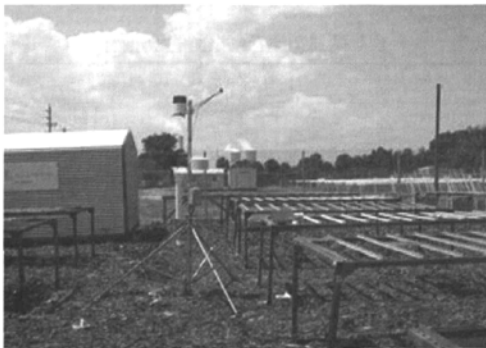
图5 在佛罗里达测量水侵蚀的试验场 (注意在样品架旁边是气象站)
