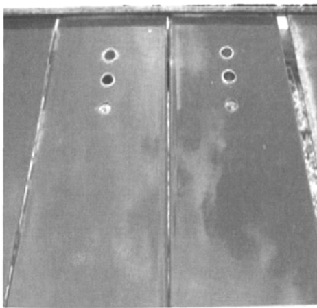
图10 在佛罗里达南部曝晒后,开裂和未开裂的涂层样品
