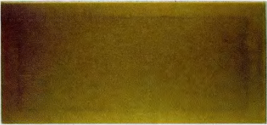
图 1 样品氙灯老化4 000 h后的外观
