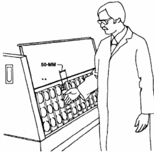
图 2. 一个样品架移开后，手距离灯源 50 毫米：允许每天曝露 1 分钟。
